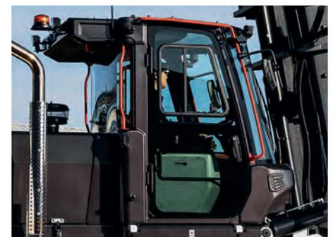
Le confort de l'opérateur est également favorisé par les deux gros filtres à air de la cabine pressurisée, qui empêchent la poussière de pénétrer dans l'habitacle. Quant au bruit et aux vibrations, ils sont minimisés.
