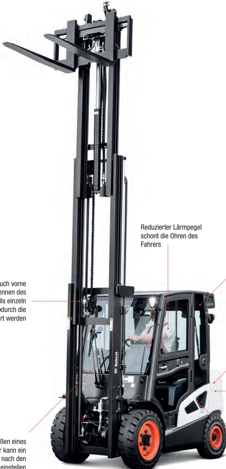
Der Hydraulikschlauch vorne kann durch Trennen des Primär-/Sekundärteils einzeln ausgetauscht werden, wodurch die Gesamtbetriebskosten reduziert werden
