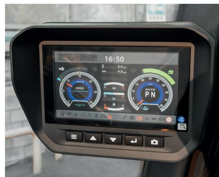
L'écran couleur de 7 pouces est astucieusement disposé à hauteur des yeux, là encore pour améliorer le confort. Il laisse une excellente visibilité sur l'extérieur et fournit des informations complètes sur l'état de la machine, pour que l'opérateur reste bien informé.
