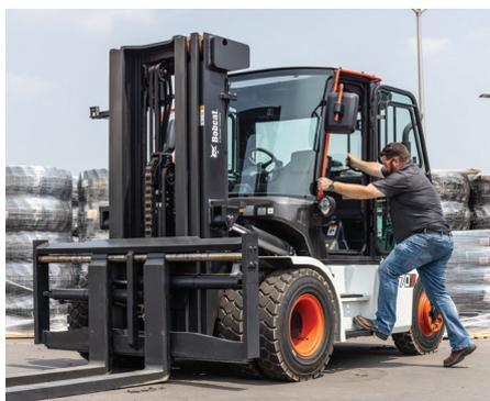
Ce chariot élévateur figure une marche placée bas qui facilite l'accès à la cabine, complétée par une barre de préhension et un plancher anti-dérapant.
