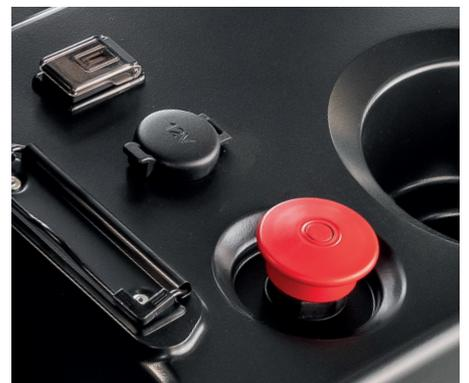
Der Not-Aus-Schalter befindet sich immer in Ihrer Reichweite und kann im Notfall einfach betätigt werden.
