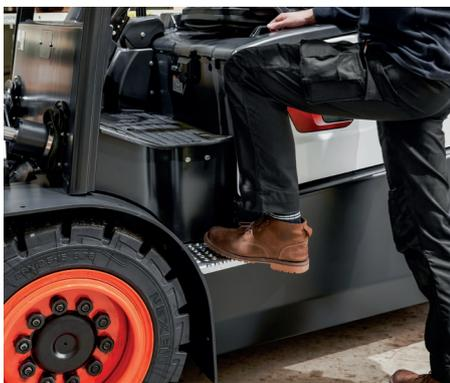
Le marchepied antidérapant vous permet de monter dans la machine et d'en descendre en toute sécurité.
