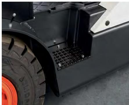
Dieser Gabelstapler verfügt über eine niedrige Stufenhöhe, die dem Fahrer einen einfachen und sicheren Ein- und Ausstieg ermöglicht – ergänzt durch einen Haltegriff und eine rutschfeste Trittstufe.
